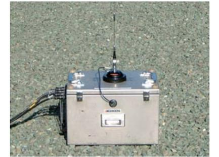
レーザー沈下計
