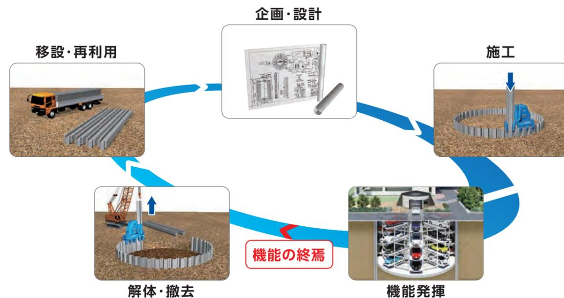
求められる期間に求められる機能を。解体・撤去を視野に入れた「機能構造物」であるエコパークは、将来的に駐車場機能が不要になった場合でも、施工時と反対の工程をたどることで簡単に撤去・原状復帰することができます。撤去した部材は再利用も可能で、持続可能な社会基盤整備に大いに貢献します。
