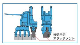
橋梁下や狭隘地など、圧入施工の完了地点で圧入機本体が撤去できない場合に、撤去可能な位置まで完成杭上を後退自走できるよう、圧入機本体のチャック(圧入杭をつかんで圧入力を加える部位)に取り付けて使用するアタッチメントです。前進自走も可能で、圧入施工の開始地点に圧入機を直接設置できない場合などの圧入機本体の前進自走にも利用できます。
