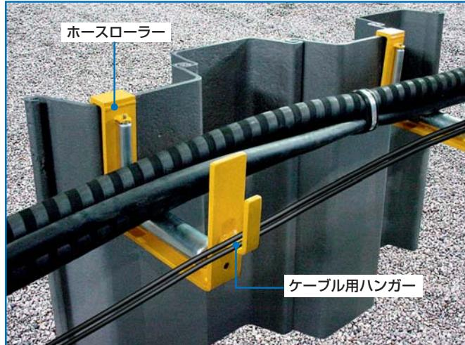
油圧ホース、ケーブルのスムーズな移動で損傷を防止します。溶接ケーブル等の細いケーブルをケーブル用ハンガーにかけ、分ける事で、ホースとの絡みや潰れを防ぎます。ホース管理の手間が省け、作業性とホースの寿命が大幅に向上します。
