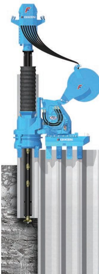
施工空間と共に克服すべき重要な制約条件が、施工地盤である。砂礫・玉石層や転石・岩盤層などの硬質地盤でも圧入の優位性を損なわず杭施工できるよう、(株)技研製作所の“芯抜き理論”を実用化し、新しい貫入促進技術として開発したのが、「硬質地盤クリア工法」である。圧入機と一体制御のパイルオーガで杭先端の直下地盤を掘削し、圧力球根の発生を抑制したまま瞬時にオーガを引抜き、同時にその間隙を埋めるように杭を地盤へ貫入させる。掘削径は最小限で排土量は少なく、環境への配慮と貫入抵抗力の低減を効果的に両立できた。
