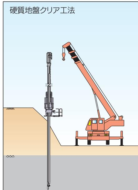
道路改良工事などの傾斜地での施工では、完成杭上を自走移動しながら施工が可能なので、仮設桟橋が不要で周辺環境への影響を最小限におさえて施工を完了することができます。
