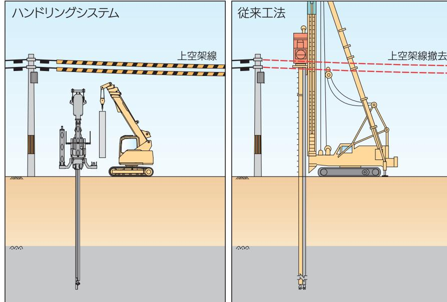
桁下や架線下など空頭制限のある場所では、コンパクトな施工機械と専用のハンドリングシステムを用いることにより、支障物の撤去なしに施工を行うことができます。
