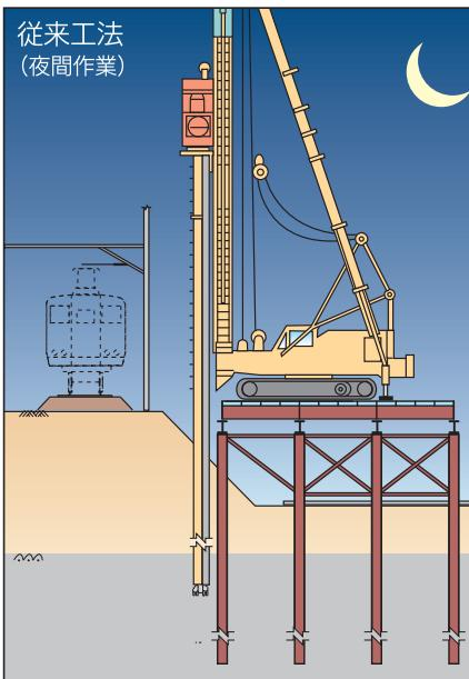
特に安全性が要求される鉄道工事では、機械が軽量・コンパクトで、転倒の危険性のない硬質地盤クリア工法であれば、供用中でも安全・確実に施工を行うことができます。
