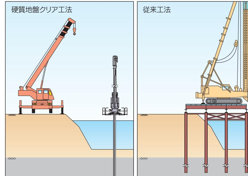
護岸改修工事、仮締切工などの河川内の施工では、完成杭上を自走移動するシステム機器を用いたGRBシステム施工を採用すれば、仮設桟橋が不要で大幅な工期・工費短縮を実現できます。
