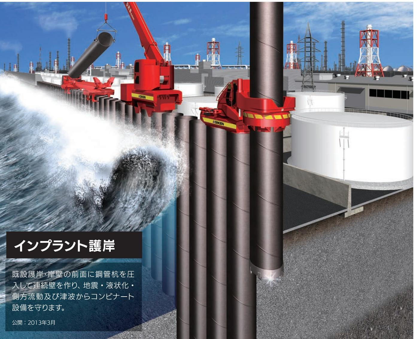
首都直下や南海トラフで発生が懸念される巨大地震。大きな揺れと大津波に加え、広い範囲で液状化の被害が危惧されています。地震と津波による複合災害からコンビナートを守り抜く力となるのが、圧入工法で築く「インプラント構造」です。
