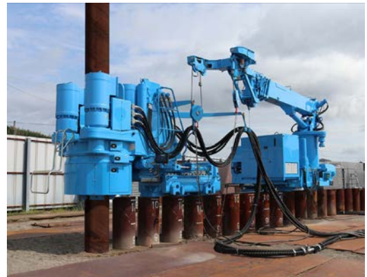
電動「ジャイロパイラー® GRV0611e」と「GRB®システム」
