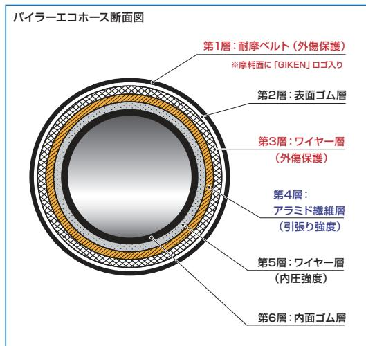
耐摩ベルトとワイヤーの二重の外傷保護層により引張強度層を保護します。損傷を最小限にくい止め、ホースの切断による作業中断を激減させます。
