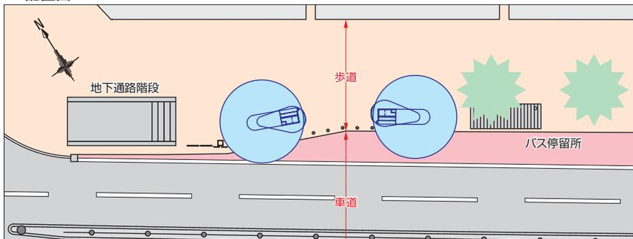
全国で初めて、道路に地下機械式駐輪場を設置。地下躯体は車道と歩道に跨り、エコサイクル躯体上部を車両が通行できる構造となっている。駐輪場管理は、付近の別の駐輪場管理棟にて一括管理をしている。
