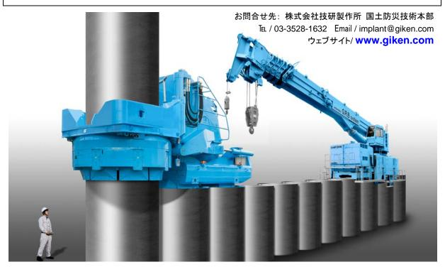
新開発の「ジャイロパイラー GRV2540(上写真左側)」は、鋼管杭を地中に回転切削圧入する圧入機 「ジャイロパイラー」の大型機で、より強靭なインプラント構造物の構築を目的に、現行のスパイラル鋼管 では最大となる直径 2.5mの大口径杭に対応した(従来機は直径 1.5mが最大)圧入機である。
