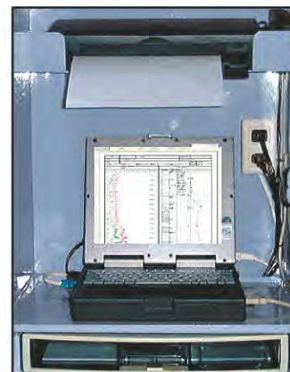
สามารถตรวจสอบสภาพการกดเข้าได้ตามเวลาจริงด้วยคอมพิวเตอร์แล็ปท็อปที่เชื่อมต่อกับชุดกำเนิดพลังงาน Power Unit
