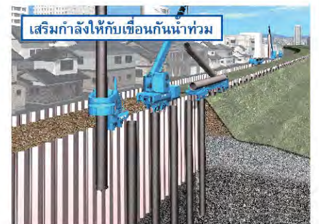
เสริมกำลังให้กับเขื่อนกั้นน้ำท่วม เหมาะสำหรับมาตรการเสริมกำลังเพื่อต้านแผ่นดินไหวและการไหลของหน้าดินด้วยการก่อสร้างที่รวดเร็ว
